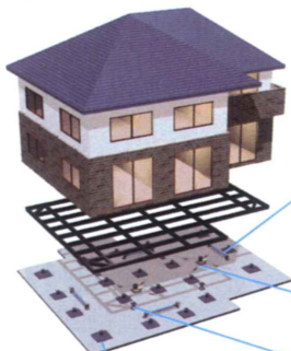
図 免震構造の概要(「ハイ免震」の場合)
