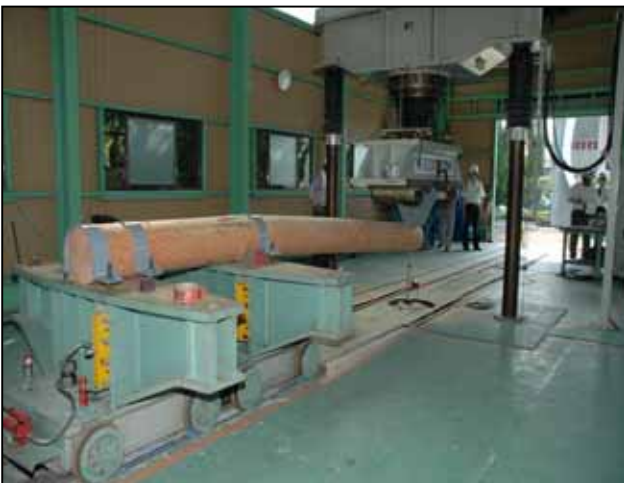
加力状況(固定側)
