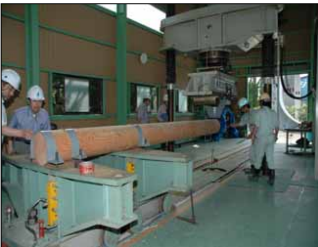
試験体設置状況
