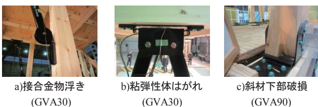
図6 試験体の損傷観察
